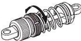
★スプリングリテーナーを回してスプリングの硬さ、車高を調整します。
